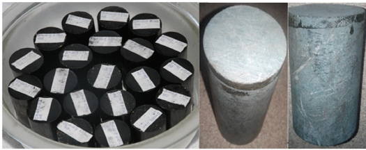
图 2 型煤和岩心试件
