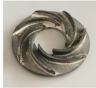
图6 叶轮磨损区域检测
