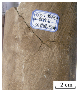
(c) 天X33-3井阜二段粉砂岩中张裂缝 (2 444.00 m)
