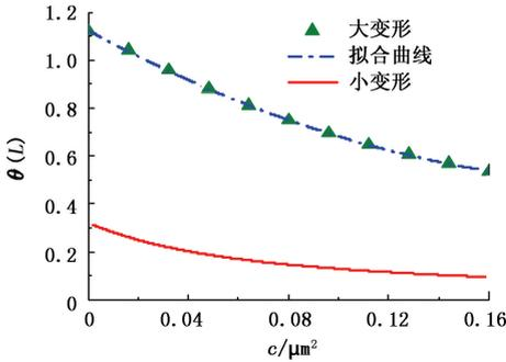
图4 悬臂梁自由端转角与梯度系数的关系
