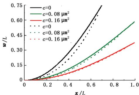
图2 悬臂梁在不同梯度系数下发生大变形和小变形时的挠曲线
