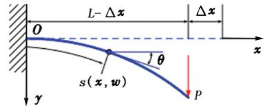
图1 悬臂梁发生大变形时的示意图
