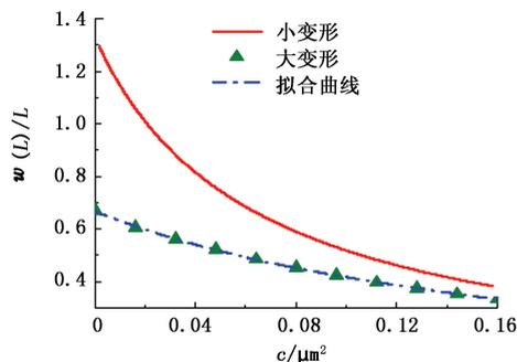
图3 悬臂梁最大挠度与梯度系数的关系
