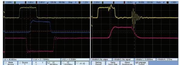
(b) 功率放大驱动电路高低位 MOS管栅源控制脉冲
