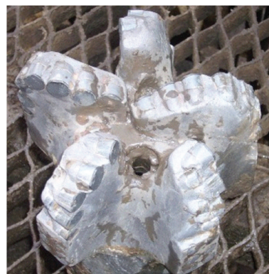
图7 BTM115Hy型钻头出井图片
