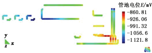
图12 阳极调整后的埋地管网电位分布
