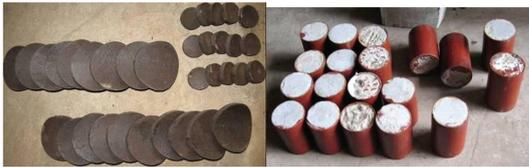
图 1 套管切片及固结好的岩样
