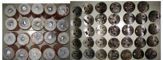
图 5 喷射后的岩心和套管片
