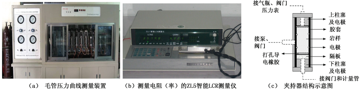
图 1 半渗透隔板法毛管压力-电阻率联测装置
