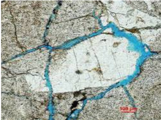
(a) 冷凝收缩缝, Z1203-4, 铸体薄片
