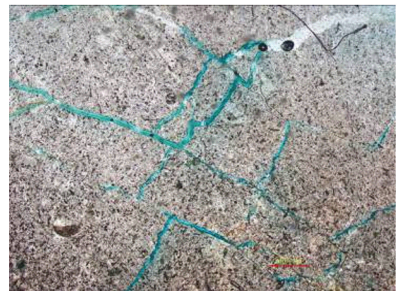
(d) 构造裂缝, 具多阶段性, 哈浅6井, 300.1 m, 铸体薄片
