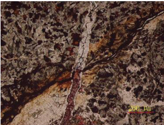
(e) 构造裂缝, 具多阶段性, 哈浅6井, 140.0 m, 正交光
